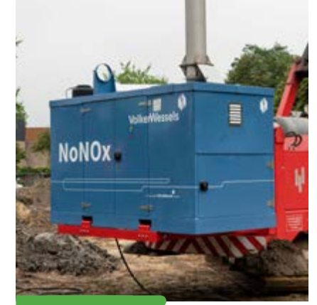
Het NoNOx filter reduceert 99% van de stikstofuitstoot van zowel stilstaand als mobiel materieel.
