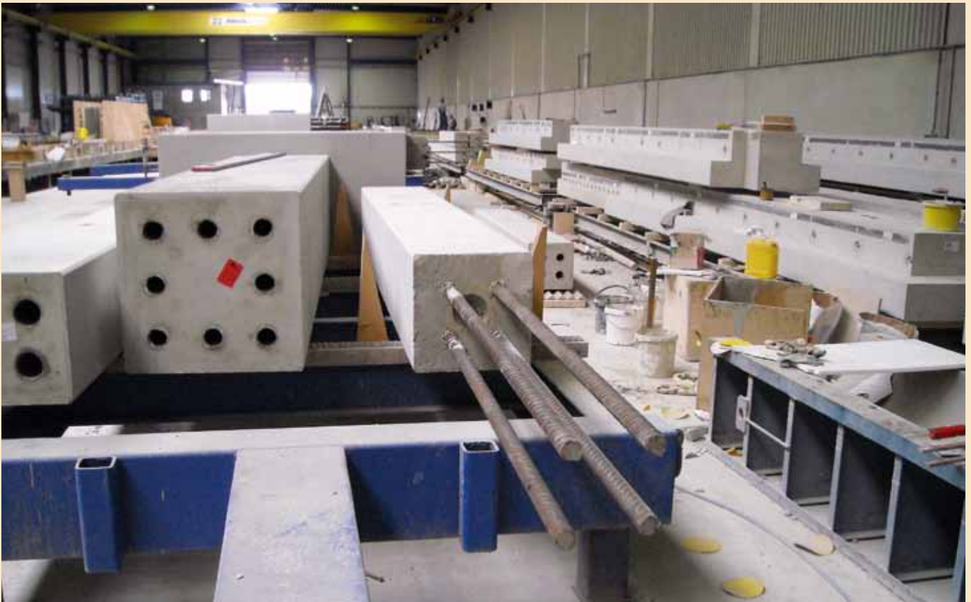
Bouwdelen worden in de fabriek gemaakt en tijdelijk opgeslagen
